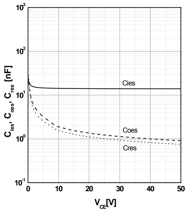
Fig8. Typ. Capacitance
