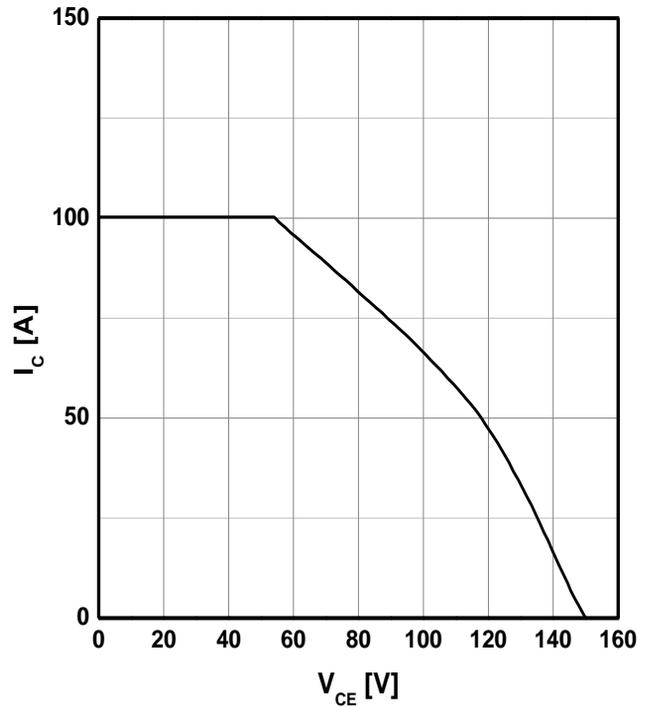
Fig6. Reverse Bias SOA ( $T_{vj} = 125^\circ\text{C}$ )
